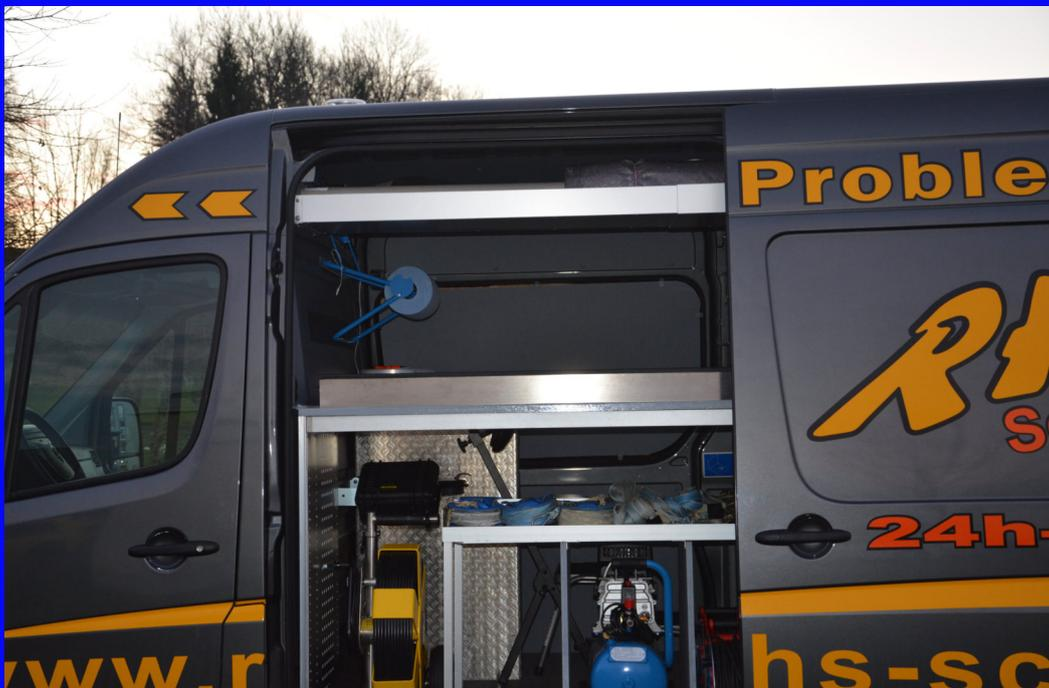
**Spezialregal für Kompressor und Schlauchtrommeln**
