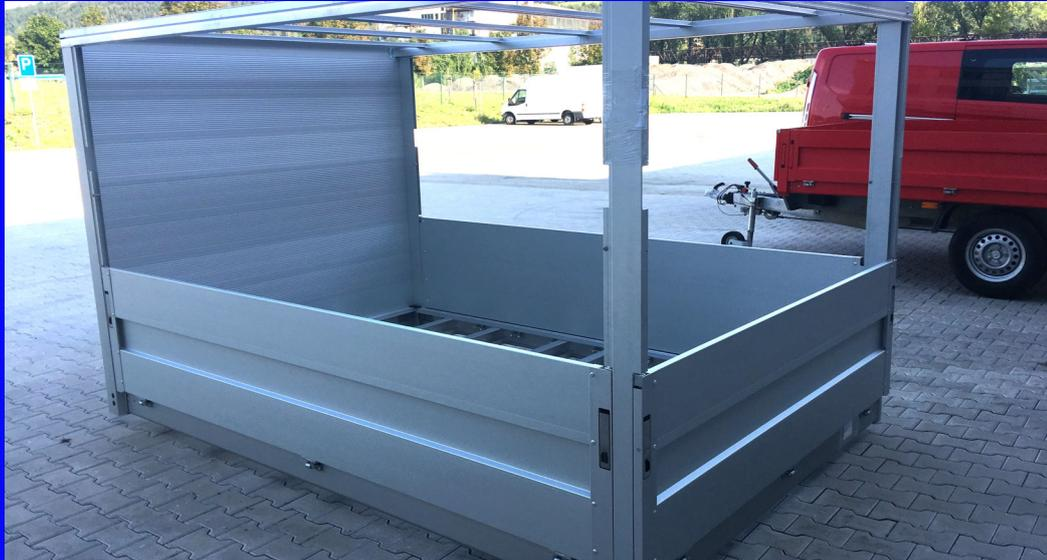
**Das Planengestell ist äußerst stabil und flexibel einsetzbar. Es besteht aus Aluminium-Vierkantprofilen.**
