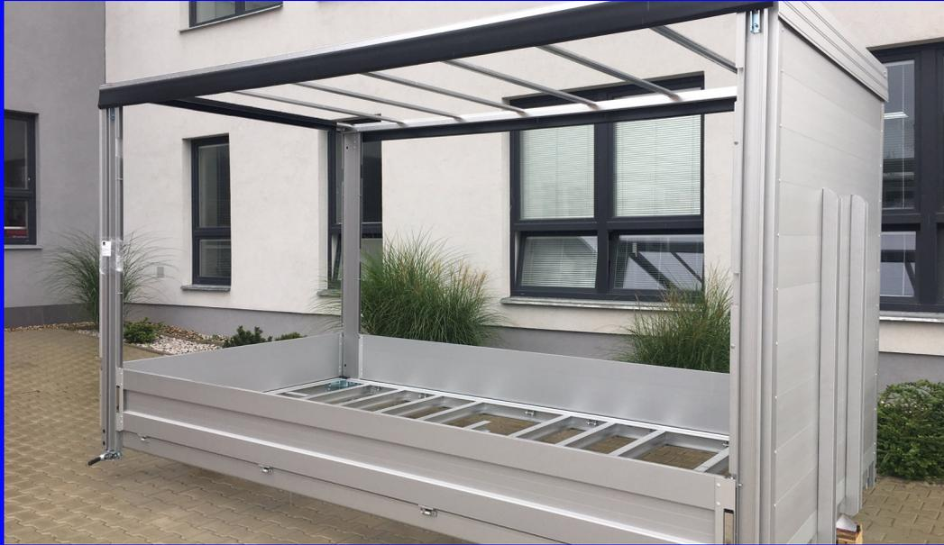
**Das Planengestell ist äußerst stabil und flexibel einsetzbar. Es besteht aus Aluminium-Vierkantprofilen.**
