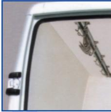
Schienen- und Rohrbahnen mit Edelstahl-Haken
