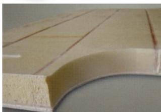
Die Innenverkleidungen bestehen aus Polyurethan Hartschaum- und glasfaserverstärktem Kunststoff (GFK) Sandwichteilen.
